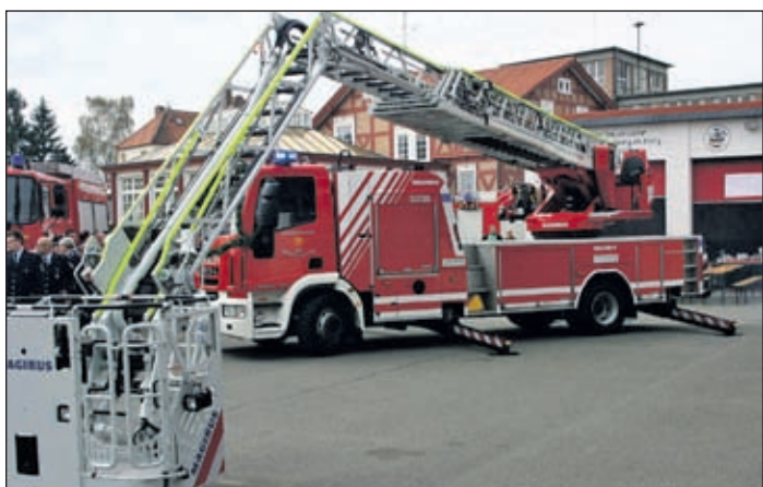
Das neue Hubrettungsfahrzeug mit dem abwinkelbaren Gelenkarm. Fotos: Bernd Jackisch
