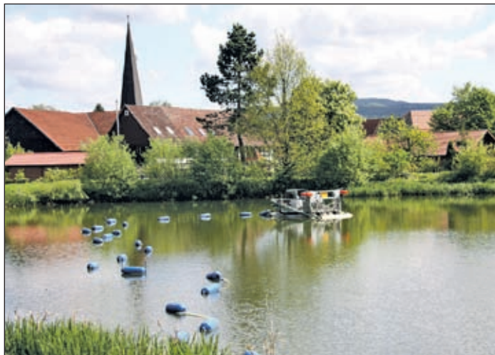
Das schwimmfähige Räumgerät auf dem Dorfteich, welches die Schlammablagerungen vom Grund des Teiches absaugt. Fotos (2): bj
